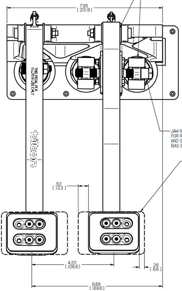
3 POSITION ADJUSTABLE PEDAL RATIO. VERTICAL POSITION ON BRAKE PEDAL:
